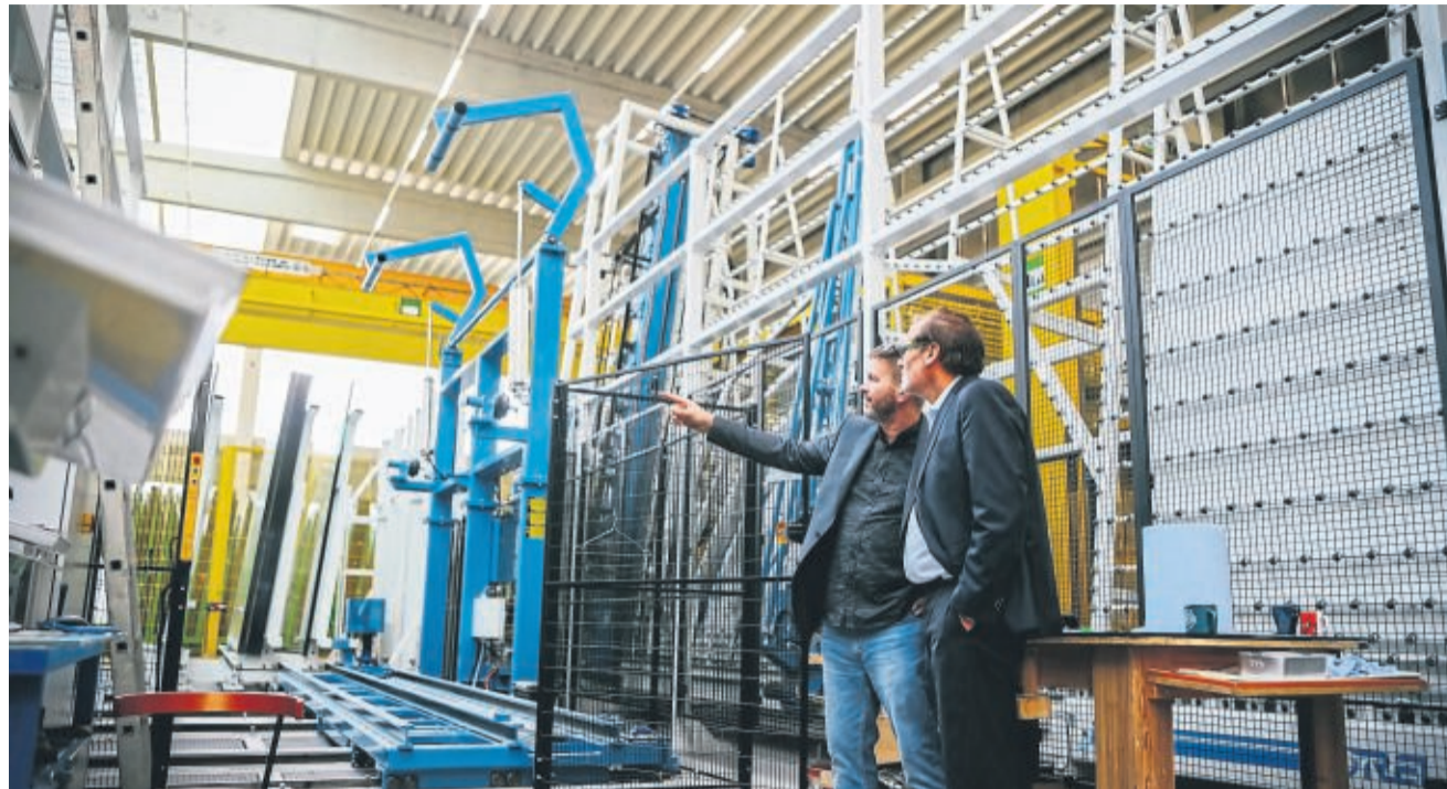
Hightech-Anlage: Landrat Bernhard Reuter (rechts) lässt sich von Geschäftsführer Torsten Bold eine Sicherheitsglas-Schneideanlage für aufrecht stehende Scheiben erklären. Sie ist ein Novum: Durch die aufrecht stehenden Scheiben lässt sich das Glas leichter schneiden und die Anlage schafft 30 Prozent mehr.
