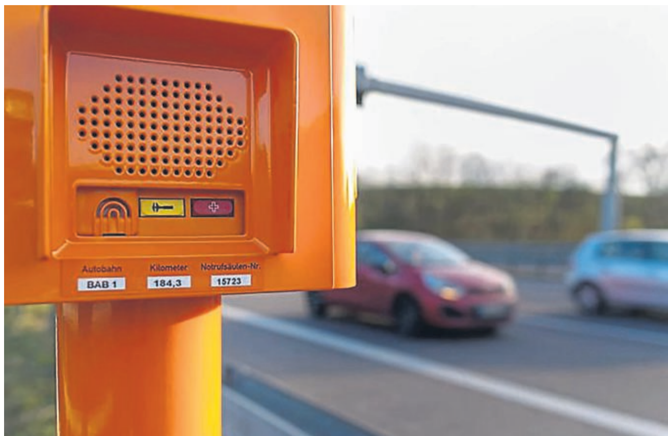
Das versteckt sich unter der Klappe: Eine Notrufsäule an der Autobahn hat einen Knopf für Pannenhilfe sowie für den klassischen Notruf bei medizinischen Problemen oder Bränden und Unfällen.
